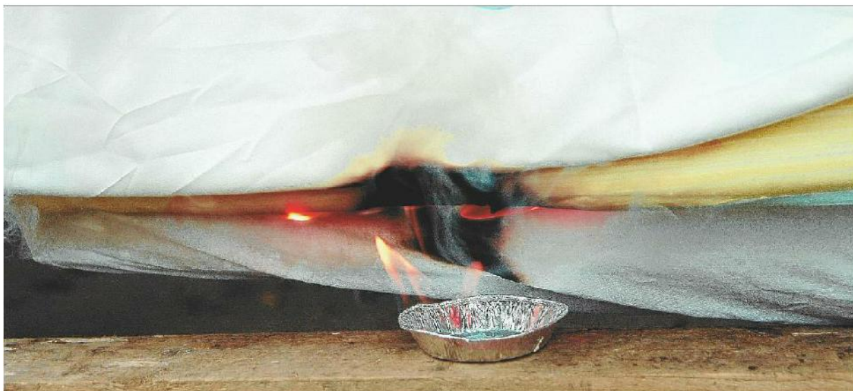
MEHR SICHERHEIT Beim Test mit Brennpaste verkohlt die Bettwäsche lediglich und geht nicht in Flammen auf. CHN
